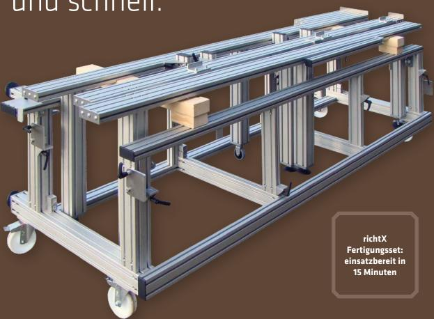
Informieren Sie sich jetzt über die innovative Segmentierfertigung! Das **richtX** ist eine mobile Fertigungsvorrichtung für den Holzrahmenbau. Mit **richtX** werden handliche Holzrahmenbausegmente direkt vor Ort auf der Baustelle gefertigt und unmittelbar zu kompletten Wänden montiert.
