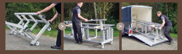
Das **richtX.bep** lässt sich auf die Rückseite kippen und wird damit zu einem Transportrollwagen. Passende Tragkonsolen nehmen die Vorrichtungsschienen aus **richtX.öff** auf. Somit lässt sich der gesamte Fertigungssatz kompakt transportieren und zur weiteren Verwendung einlagern.
