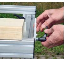
Beplankungssegmente bestehen aus Holzrippen, Holzwerkstoffplatten sowie deren Befestigung. Die Rippen werden in eine regalähnliche Vorrichtung gelegt. Die Breite und Länge der Rippen ist beliebig und stufenlos einstellbar. Präzise Endanschläge definieren das horizontale Schwellenauflager der Rippen.
